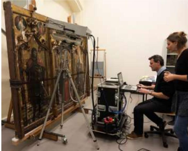
Analyse de matériaux par spectroscopie LIBS - LRMH
