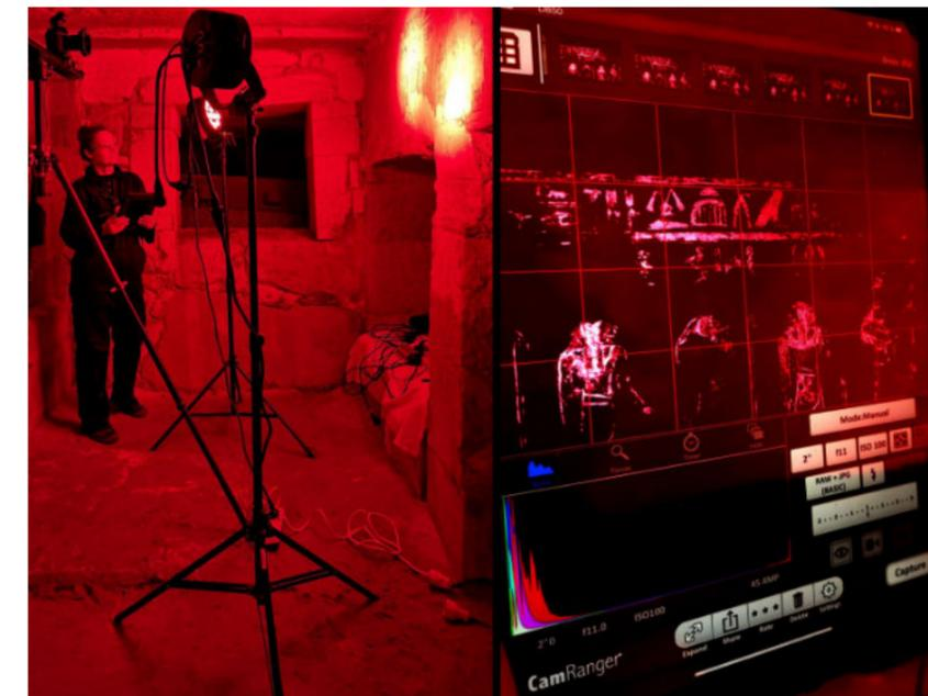
Prise de vue des fluorescences du pigment bleu égyptien dans le proche IR sous LEDs émettant à 610 nm avec observation directe sur écran, paroi Ouest de l'antichambre de la tombe de Psousennès 1<sup>er</sup>, Tanis, Egypte.
