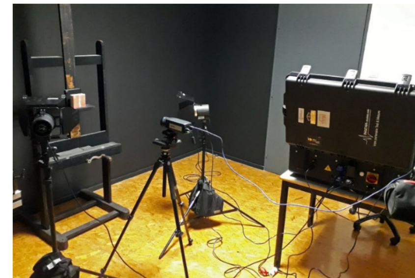
*Premières expérimentations sur éprouvettes utilisant le système Thermo-Art pour la thermographie IR stimulée.
