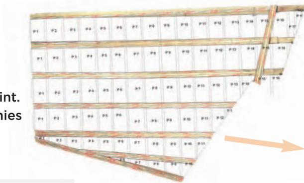
**Fig.7** Dessin vu d'en bas et direction de la pente (nord-sud 6%) pour l'évacuation des eaux pluviales
